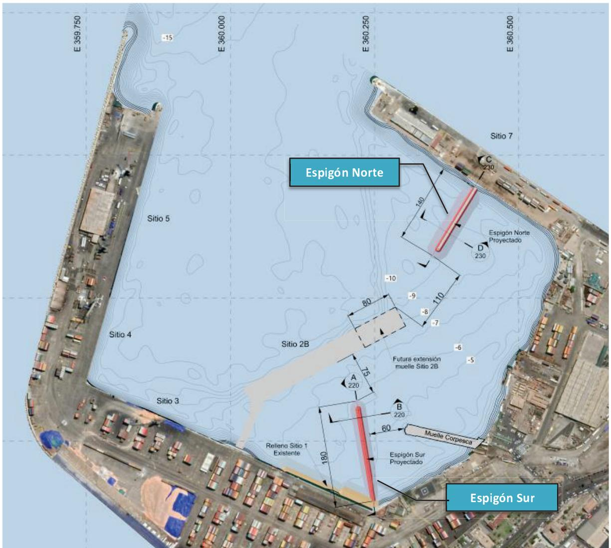
*Figura 4-2 Disposición general de la alternativa de espigón Sur y Norte. Ref: EPA-2104-DIB-010-A Planta General*
