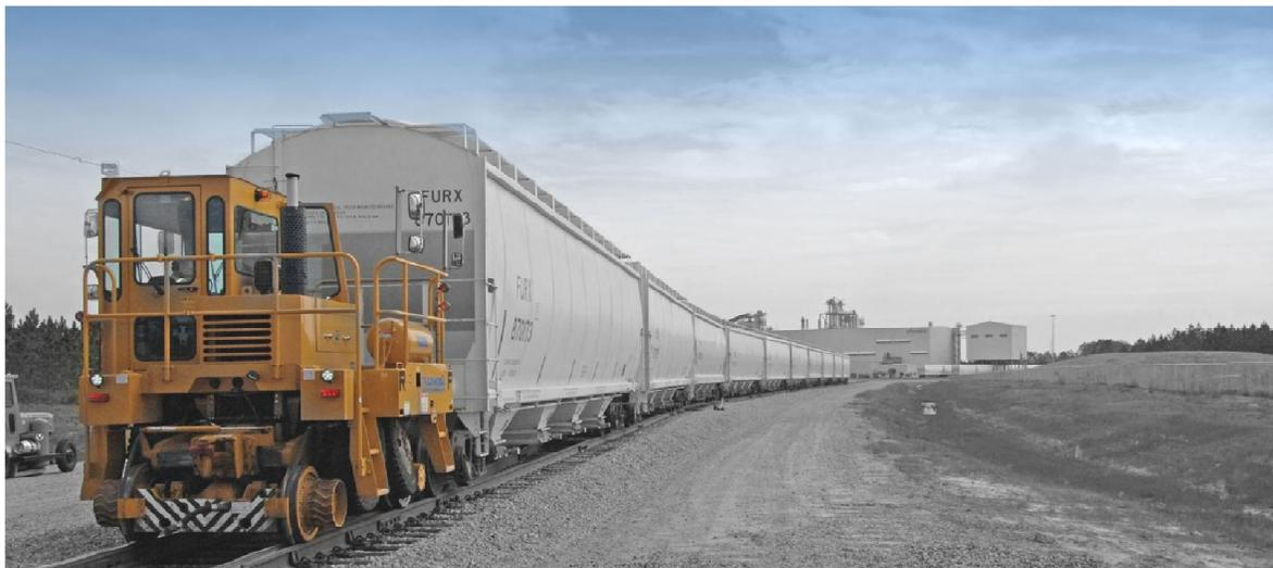
El track mobile pese a ser un equipo liviano, puede arrastrar varios carros pesados, ya que mediante una técnica hidráulica puede transferir parte del peso del equipo que arrastra, a sus ruedas aumentando así el poder de arrastre.
